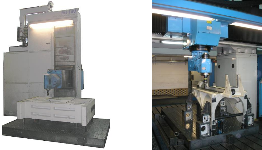
Abb. 1 Fahrständer- und Genauigkeits-Portalfräsmaschine (Werkbilder Heidenreich & Harbeck Casting GmbH)
